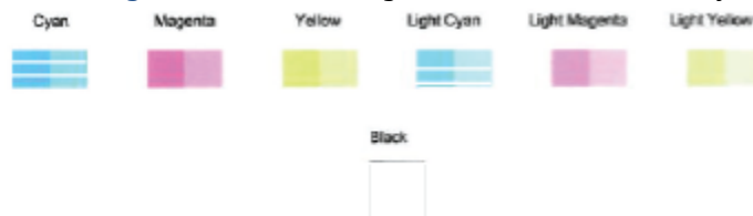
Afbeelding 9-2 Voorbeeld van gekleurde blokken met afwijkingen
